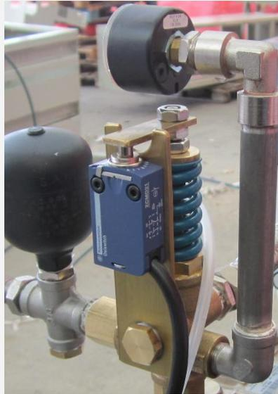
**Bomba dosificadora**, inyecta el producto químico hasta llegar a la lanza, esta dosificadora tiene la posibilidad de seleccionar tres posiciones de trabajo, esta selección se puede realizar mediante un selector en el cuadro eléctrico.
