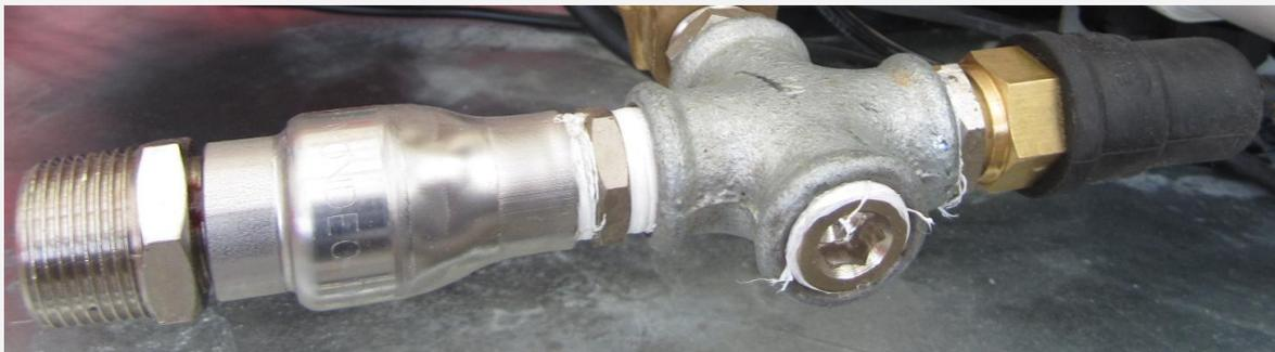
**Válvula reguladora.** Este regulador de presión cierra un contacto cuando llega a la presión establecida. Arranca y para la bomba de presión cuando se produzcan cambios de presión en la tubería al utilizarse la lanza.
